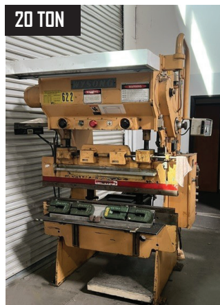
20 TON Wysong H2052, 52" x 20 Ton Hydraulic Press Brake.
