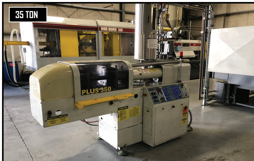
BATTENFELD PLUS 350, 35 TON PLASTIC INJECTION MOLDER.
