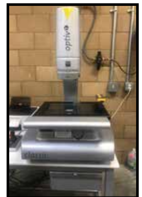
Optiv 2008 Brown & Sharpe Optiv 1 mdl. 06830202 Video CMM Machine
