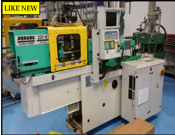
Arburg Allrounder 221k-250-75, 25 Ton Injection Molding Machine.
