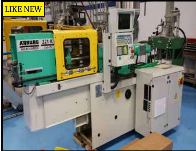
Arburg Allrounder 221k-250-75, 25 Ton Injection Molding Machine.
