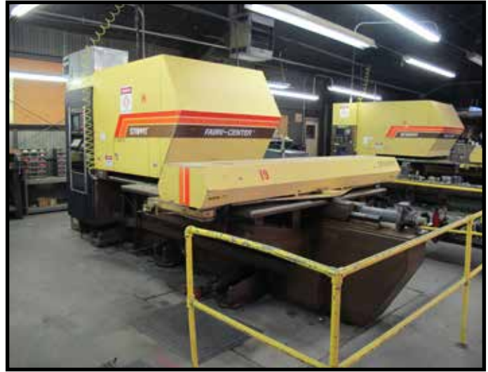
STRIPPIT FC 1000 III, 33 TON CNC TURRET PUNCH W/HOUDAILLE CONTROL, S/N: 187111284
